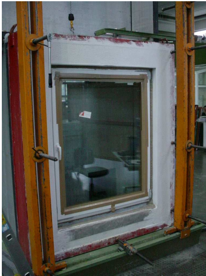
Bild 1 Probekörper auf dem Fensterprüfstand aufgebaut
