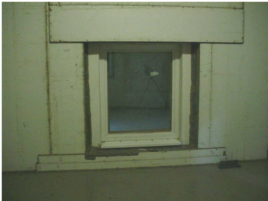
Bild 8 Probekörper eingebaut im Wandprüfstand zur Ermittlung der Schalldämmung des Probekörpers.
